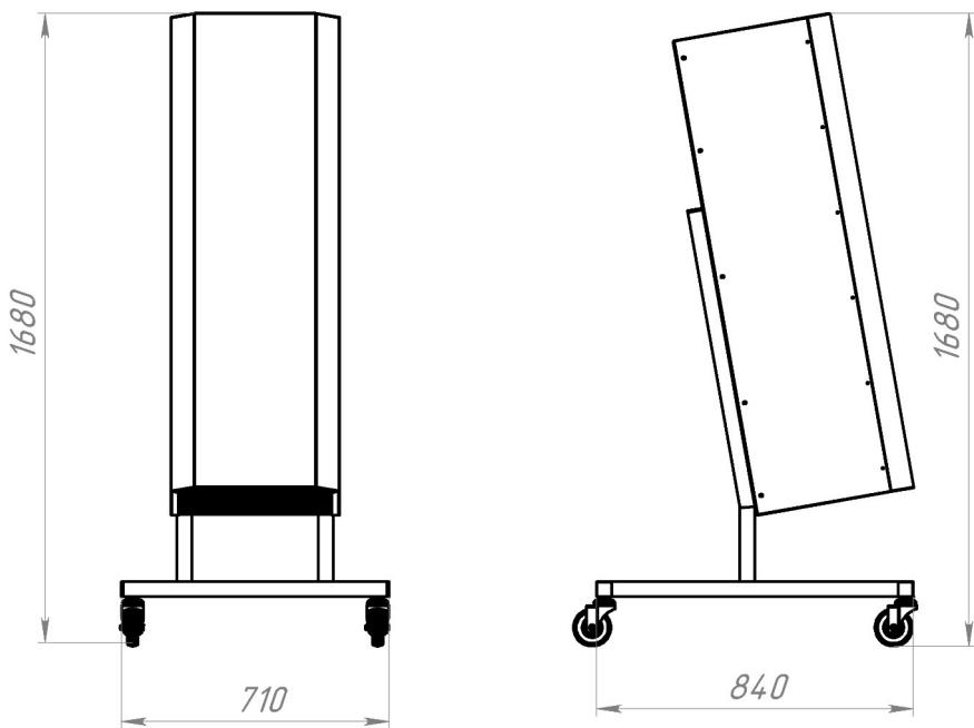
Рис.1 Общий вид облучателя-рециркулятора бактерицидного ОР-УФ-600СО.
