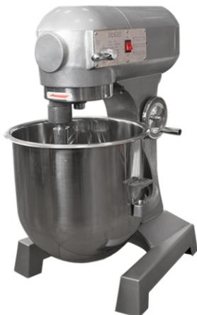
Все детали, имеющие контакт с пищей, выполнены из нержавеющей стали. Комплектация: крючкообразная мешалка, мешалка-венчик, мешалка-лопатка. Две скорости взбивания - 170/340 об/мин.
