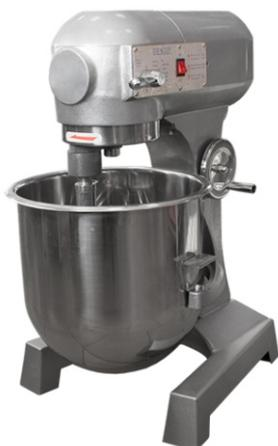
Все детали, имеющие контакт с пищей, выполнены из нержавеющей стали. Комплектация: крючкообразная мешалка, мешалка-венчик, мешалка-лопатка. Три скорости взбивания - 105/180/425 об/мин.
