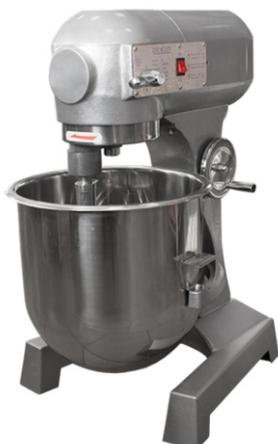
Все детали, имеющие контакт с пищей, выполнены из нержавеющей стали. Комплектация: крючкообразная мешалка, мешалка-венчик, мешалка-лопатка. Три скорости взбивания - 110/200/420 об/мин.
