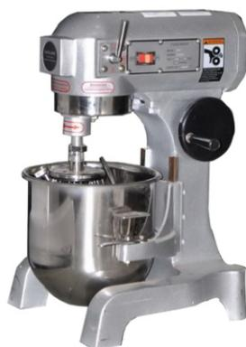
Все детали, имеющие контакт с пищей, выполнены из нержавеющей стали. Комплектация: крючкообразная мешалка, мешалка-венчик, мешалка-лопатка. Две скорости взбивания - 170/340 об/мин.
