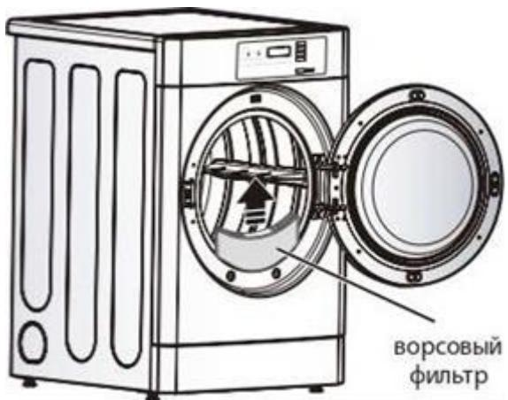
Для выполнения очистки откройте дверцу сушильной машины и потяните ворсовый фильтр в направлении строго вверх. Затем:
