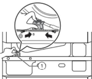
4. Установите задний кронштейн для укладки на заднюю часть штабелируемой машины и затяните четыре (4) винта.
