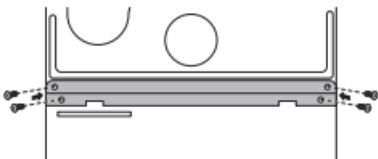
5. Для приведенной выше машины необходимо изменить положение панели, затем собрать ее и зафиксировать с помощью винтов.
