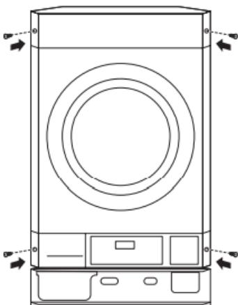
6. Соберите и закрепите нижнюю панель машины с помощью винтов.
