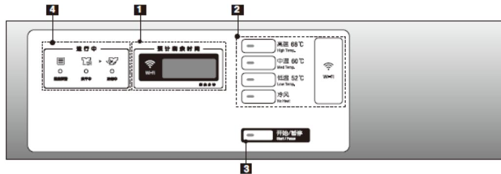
1. LED Дисплей 2.Кнопка цикла 3. Кнопка Старт /Пауза 4. Светодиодный индикатор состояния
